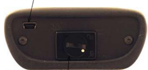
Batterirum 2 x AA batterier.
